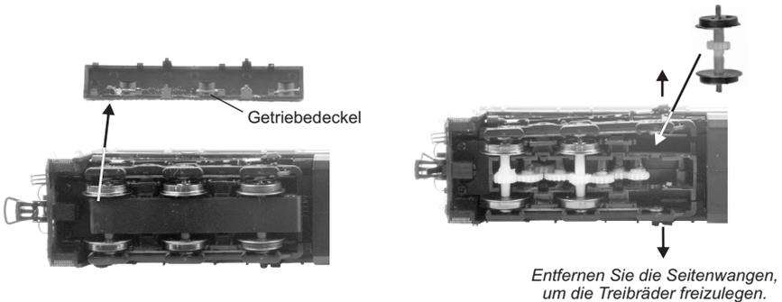
2. Entfernen Sie die Fahrgestell-Seitenwangen vom Antriebsblock, um die Treibachse aus dem Getriebe zu heben (siehe obige Abbildung).
