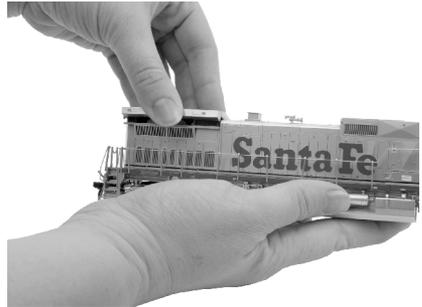
Um den Dachdeckel zu entfernen, ziehen Sie diesen behutsam nach außen und heben ihn von der Seitenwand ab.
